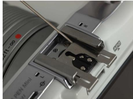
Man hebt mit der Stecknadel am objektivseitigen Ende des Blitzschuhs das Blech hoch und schiebt es in Richtung Display aus dem Schuh. Darunter kommen die Schrauben zum Vorschein. Diese müssen einfach festgezogen werden. Fertig. Nicht vergessen, das Federblech wieder zurückzuschieben.
