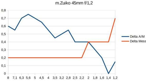
Die Kurve des m.Zuiko 45mm f/1,2 ähnelt stark der Kurve des Nocticon. Die Linie *Delta Mess* steigt etwas später an.
