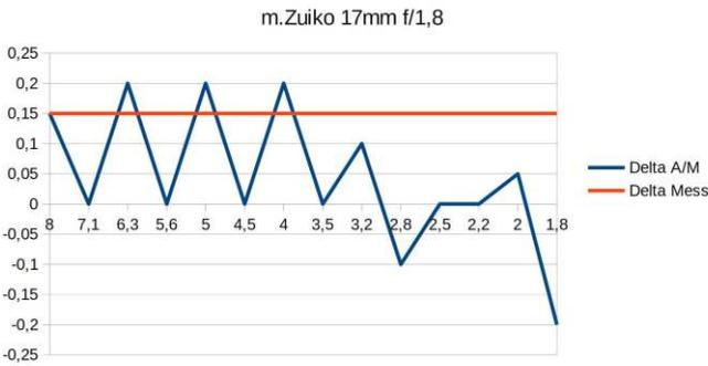
Die Belichtungsanpassung für das 17mm liegt lediglich bei 1/6 Lichtwert. Man sieht, dass die Blendenmechanik des 17mm nicht sehr hochwertig ist.
