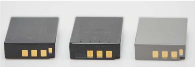
*Man sieht's eigentlich nicht, aber die beiden linken Akkus sind gebläht. Der Clone ganz links so weit, dass er nicht mehr in die Kamera passt. Mit einem aufgelegten Lineal oder einer Visitenkarte kann man dem trotzdem auf die Spur kommen.*
