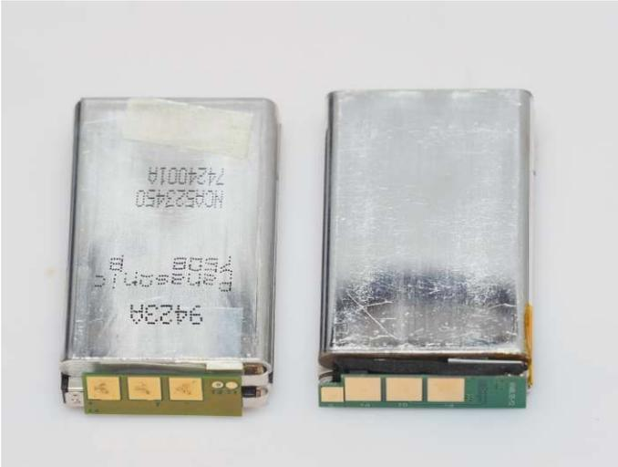
*BLS-Akku. Links Original BLS-1, rechts Clone BLS-5. Der Clone hat TMB-Zellen, das Original Panasonic-Zellen. Der Clone hat eine einzelne Sicherung am Pluspol, (weißer Streifen, das Original hat in beiden Zuleitungen zu den Zellen Thermosicherungen, die mit metallischer Kontaktplatte auf die Zellen geklebt sind - man sieht den Tesafilm.*
