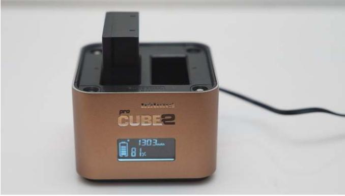
*Ein Hähnel ProCube2. Keine Temperaturüberwachung, keine digitale Schnittstelle. Schnellladefähig.*
