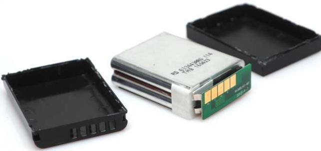
*Die drei Teile eines Clones. Dieser Clone hat kein Load-Balancing und nur eine Sicherung.*
