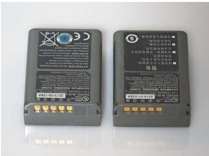
*Das beliebte Spiel: Original und Fälschung. Links echt, rechts Fälschung. Der echte Femost-Akku unterscheidet sich durch zwei Dinge: Bei den Fälschern schreibt man „Japan“ klein - und der fehlende Aufkleber neben den Kontakten.*
