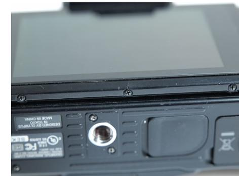
*E-M5 mit gerissenem Displayrahmen. Der Fehler wurde innerhalb der Garantiezeit von Olympus kostenfrei behoben. Neben dem Stativgewinde die Gummabdeckung für die Kontakte des HLD-6.*
