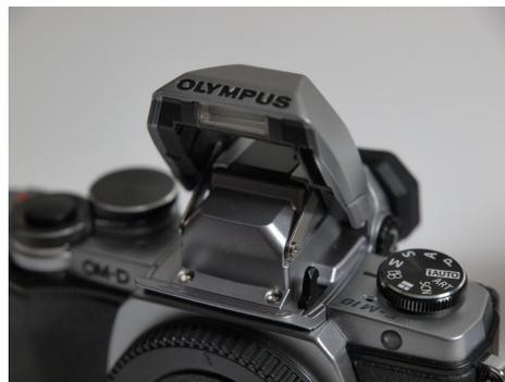
*Der aufgeklappte Blitz der E-M10.*
