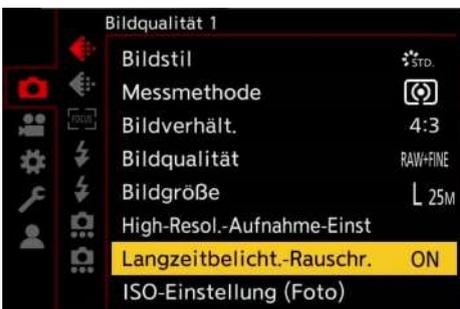
Der Parameter sollte auf "On" stehen, außer Sie wissen sehr genau, was Sie tun. Astrofotografen machen oft hunderte Bilder schnell hintereinander - der automatische "DarkFrame", der immer genau so lange braucht, wie die Belichtung selbst, würde das Ganze Prozedere auf die doppelte Zeit ziehen. Deshalb machen sie vor und nach der Belichtung einen eigenen Darkframe um damit dann in der Nachbearbeitung das Rauschen zu entfernen.
