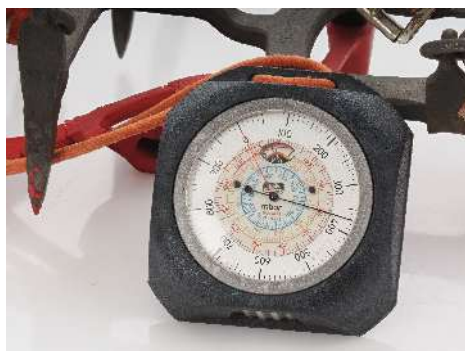
Ein klassischer Höhenmesser. Funktioniert ohne Strom und wird einfach bei jeder Hütte und jedem Gipfel auf die aktuelle Höhe eingestellt. Auch als Barometer verwendbar... Die Steigeisen im Hintergrund sind natürlich rein historisch. Sowas nicht mehr verwenden!
