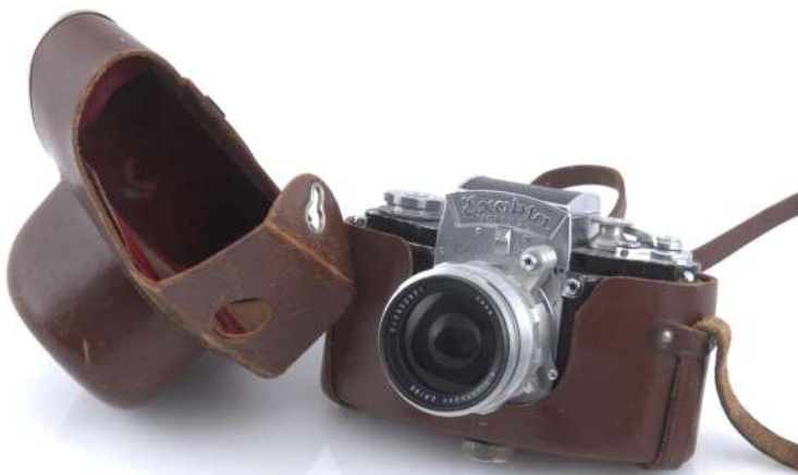
Eine Exakta mit 35mm Flektagon in Bereitschaftstasche. Das Objektiv ist nicht eingearastet. Sonst wäre der Auslöser der Springblende über dem Auslöser. Der Auslöser an der Vorderseite hat den großen Vorteil, dass man mit rechts alle Einstellungen machen kann - und - vor allem - die Kamera ist auch mit Fäustlingen bedienbar.
