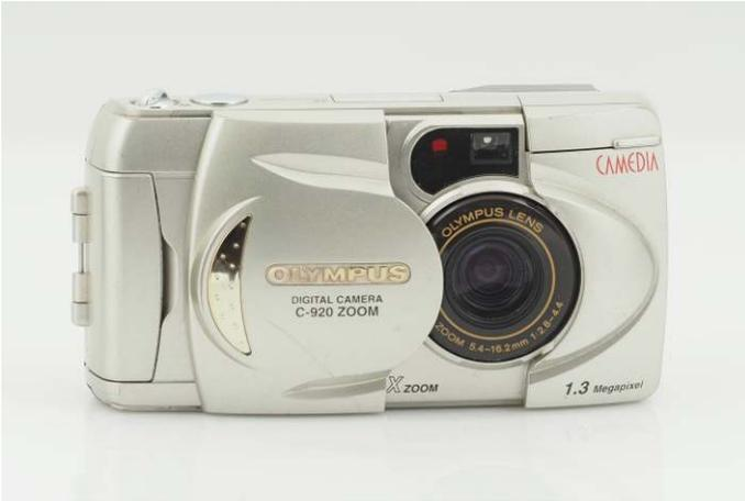
*Eine der frühen digitalen Kameras von Olympus: Die C-920 Zoom von 1999. Auflösung 1280x960, 1/2,7"-Sensor, 3-fach Zoom, Neupreis knapp unter 1000 Mark. Optischer Sucher und eingebauter Blitz - Verschlusszeiten von 1/1.000s bis eine Sekunde.*
