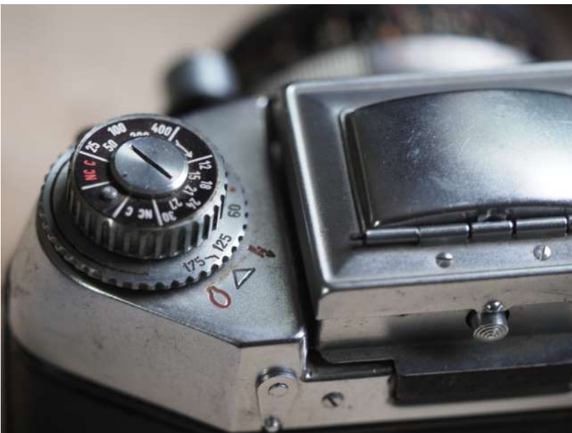
Alte EXA mit Tuchverschluss und kürzester Belichtungszeit von 1/175s. Oben auf dem Rad ist eine Blechscheibe, auf der man zur Erinnerung die Filmempfindlichkeit einstellen konnte. Einmal mit ISO, (25-400) einmal mit DIN (12-30)
