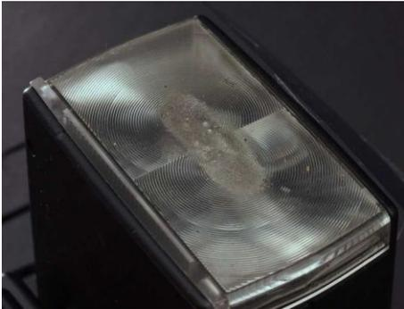
*Metz 54 mit angeschmolzener Streuscheibe. Bisweilen finden sich in der Schmelze auch Farbpartikel der Filterfolien. Ein solcher Schaden ist nur durch Austausch der Scheibe bei Metz zu reparieren.*
