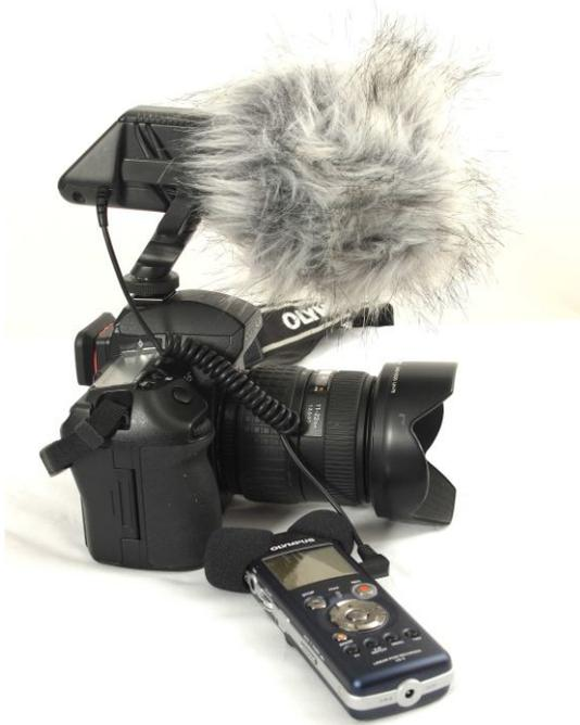
*Rode StereoVideoMic mit mitgeliefertem "Dead-Cat" Windschutz. Im Gegensatz zu den im LS-5 eingebauten Mikros besitzt das Rode Mic eine ausgeprägte Richtcharakteristik.*
